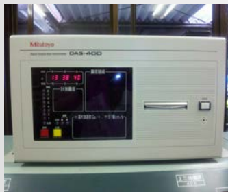
地震計震度表示装置
