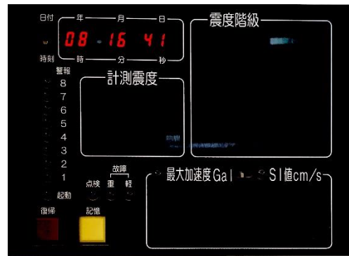
地震計震度表示装置
