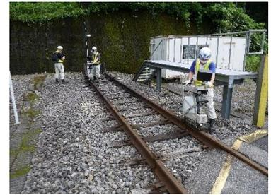
手押し式の超音波探傷検査
