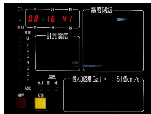
地震計震度表示装置
