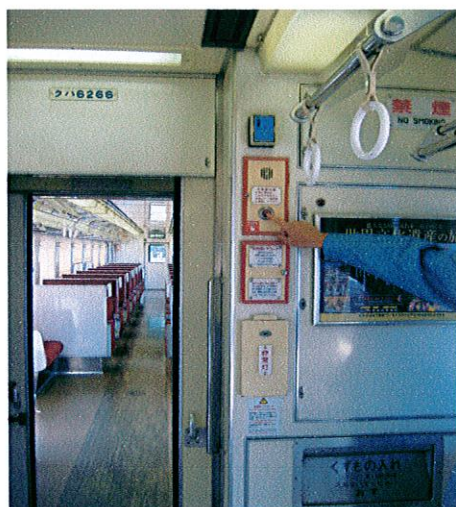
(車内の非常報知器)
