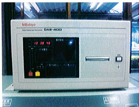
(地震計震度表示装置)
