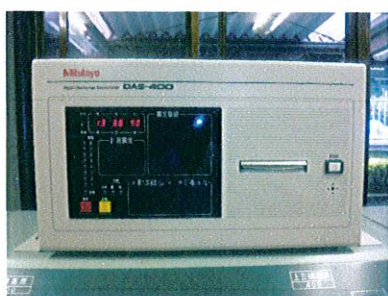
(地震計震度表示装置)
