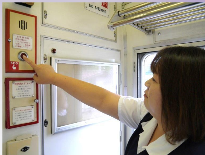
車内の非常報知器
