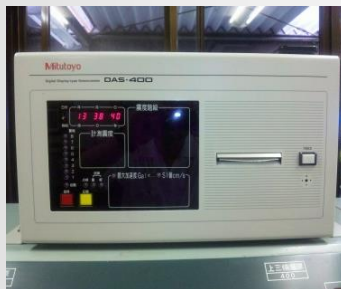
地震計震度表示装置
