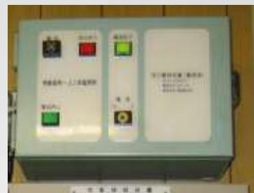
落石検知表示装置
