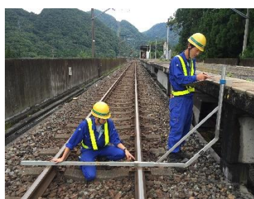
駅ホームの離れ及び高さ測定
